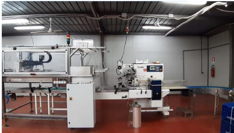
Figure 2. Machine Flow Pack pour l'intégration du dispositif BlowDevice® dans les films d'emballage de l'exploitation agricole Romanazzi
