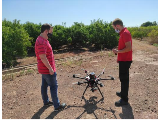
Εικόνα 3: Drone εξοπλισμένο με θερμογραφικές κάμερες
