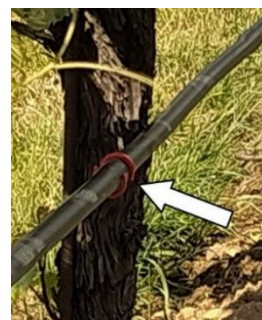
Fig. 3. Clipes de irrigação Hydro aplicados aos sistemas gota a gota para os fechar e modular a distância e obter um sistema de gotejamento de taxa variável
