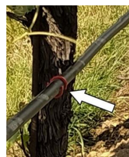
Figura 3. Pinzas de riego aplicadas a los goteros para cerrarlos y modular la distancia y obtener un sistema de goteo de caudal variable
