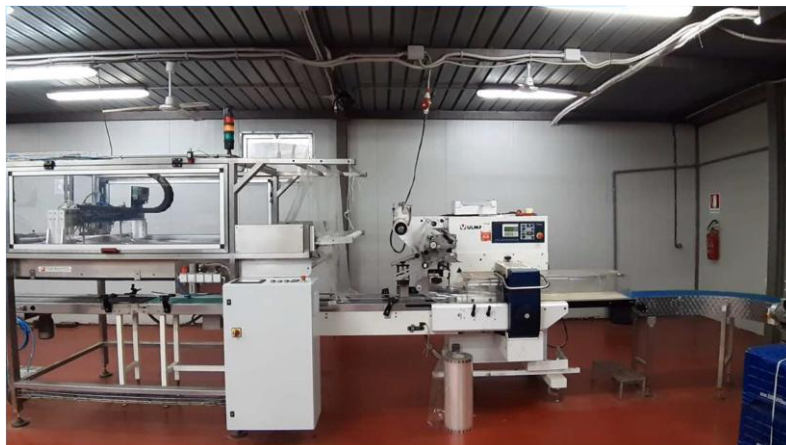
Figura 2. Máquina de embalar em fluxo para a inserção do BlowDevice® em embalagens de película na empresa Romanazzi
