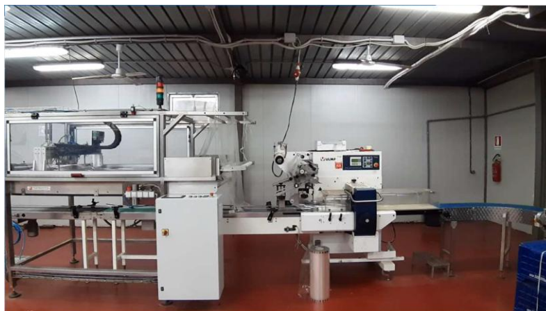
Figura 2. Confezionatrice flow pack per l'inserimento di BlowDevice® nelle confezioni con pellicola presso l'azienda Romanazzi
