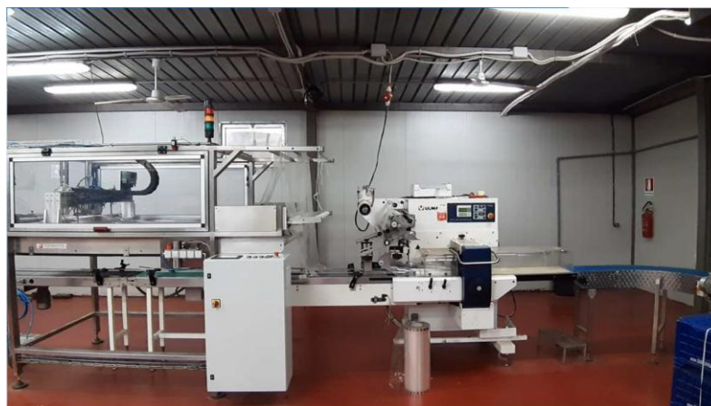
Slika 2. Pakirni stroj s tekućom vrpcom za umetanje uređaja BlowDevice® u foliju u tvrtki Romanazzi
