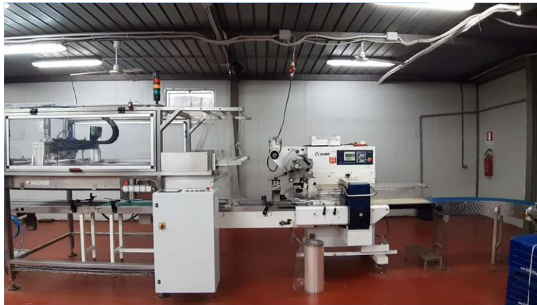
Εικόνα 2. Μηχανή συσκευασίας ροής για την εισαγωγή BlowDevice® σε μεμβράνες συσκευασίας στην εταιρεία Romanazzi
