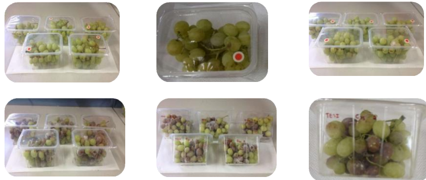
Εικόνα 4: Βιολογικά επιτραπέζια σταφύλια αποθηκευμένα σε συσκευασία τροποποιημένης ατμόσφαιρας (MAP) εξοπλισμένη με BlowDevice ®
